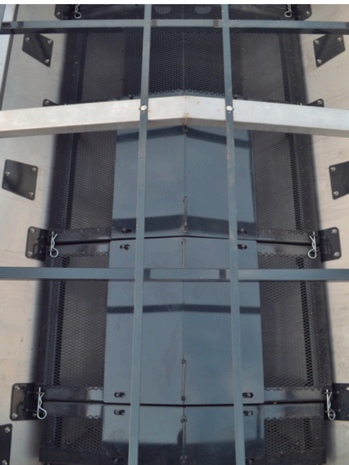
Rejillas interiores y protección para granulados. Protección en Sombrero Chino para polvos.
